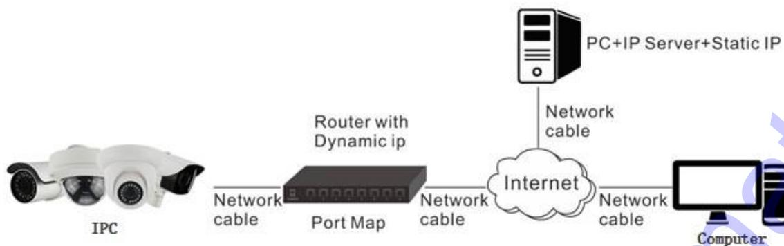
**Шаг 1:** Установите и запустите IP сервер на ПК со статическим IP адресом.
