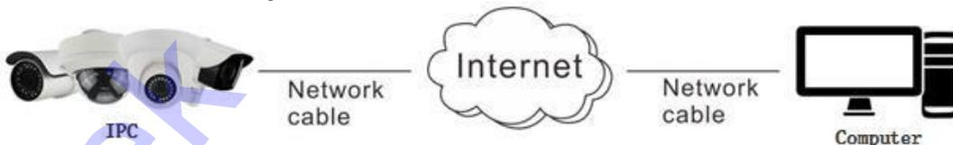
Вы также можете использовать статический IP адрес для подключения камеры напрямую к интернету без использования маршрутизатора (роутера). Статический IP адрес необходимо получить у вашего поставщика услуг интернета. Более подробную информацию см. в разделе 7.3.1.
